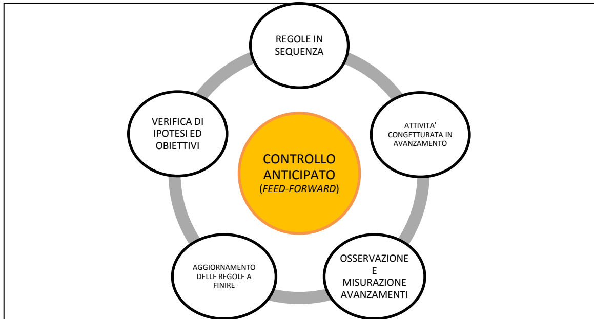
Fig. 10 - Processo di controllo predittivo o feed-forward
