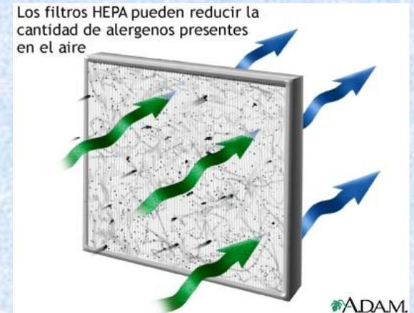
I filtri HEPA sono in grado di garantire al 99,97% il filtraggio di particelle di diametro uguale o maggiore a 0,3 micron. Detti filtri sono inefficaci nei confronti di gas o vapori.
